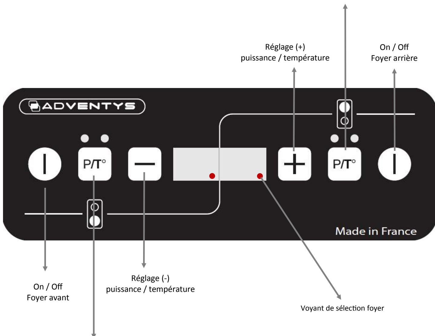
Réglage puissance / température et sélection foyer avant :
